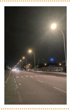
Ces travaux ont été confiés au Syndicat départemental d'énergie de l'Aube (SDEA), qui après une étude d'éclairement, a remplacé les appareils existants par des luminaires en fonte d'aluminium équipés de LED de rendu « blanc chaud », qui permettent un éclairage qualitatif, uniforme - et de la consommation d'énergie - pour une partie de la nuit. Ils fonctionnent à 70% de leur puissance toutes les nuits entre 22h et 6h.
